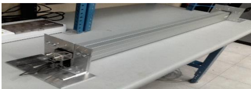
IMAGEN 8: Montaje del detector híbrido de 24 canales compuesto por 6 celdas híbridas de detección de rayos cósmicos.
