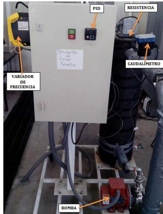
IMAGEN 2: Circuito de Simulación de Carga.
