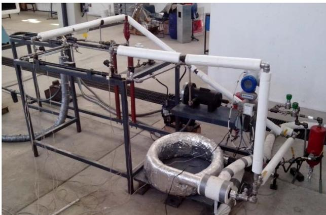
IMAGEN 1: Circuito de Compresión de vapor.
