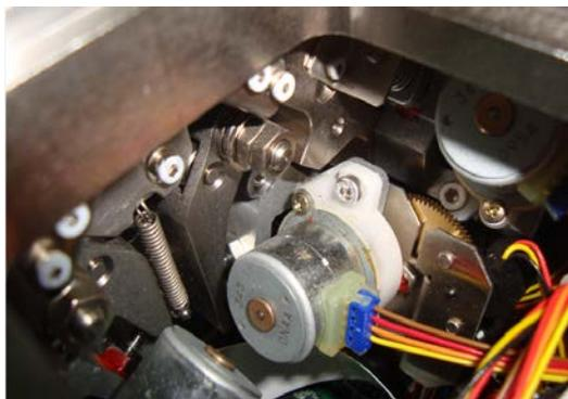
FIGURA 2. Motor de pasos en un espectrógrafo de IR.
