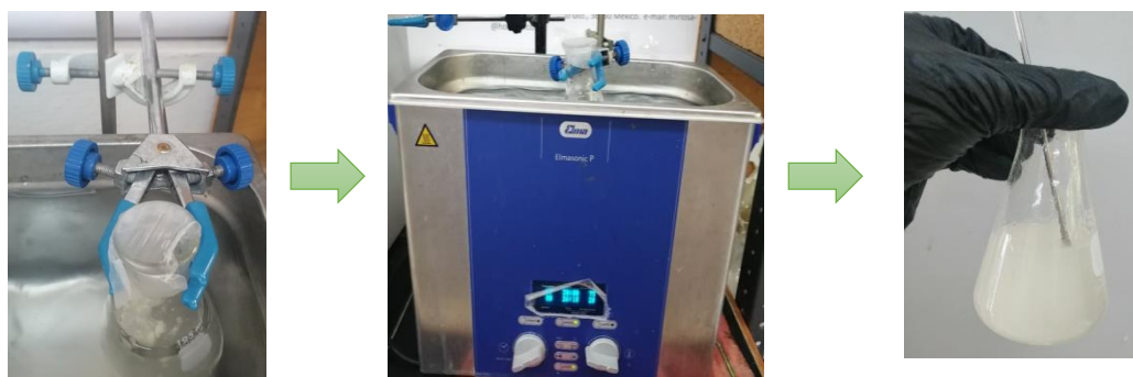
Figura 9.7. Disolución del quitosano en ácido acético en un baño ultrasónico
