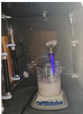
Figura 9.4. Una vez añadido el \text{AgNO}_3 o \text{Ag}_2\text{SO}_4 se coloca en un foto-reactor con lámparas con longitud de onda de 254 nm.
