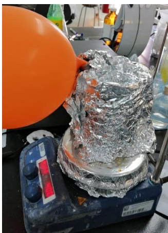
Figura 9.3. ZnO con agua desionizada y etanol en oscuridad con burbujeo de N_2
