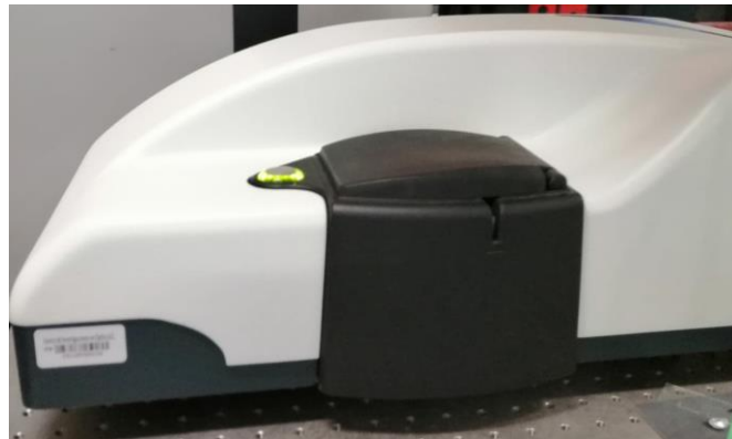
Figura 10.1 Equipo Zetasizer nanoseries para la caracterización por DLS
