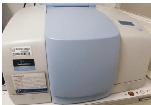
Figura 10.3 Espectrómetro FT-IR Perkin Elmer Spectrum 100
