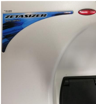
Figura 10.1 Equipo Zetasizer nanoseries para la caracterización por DLS
