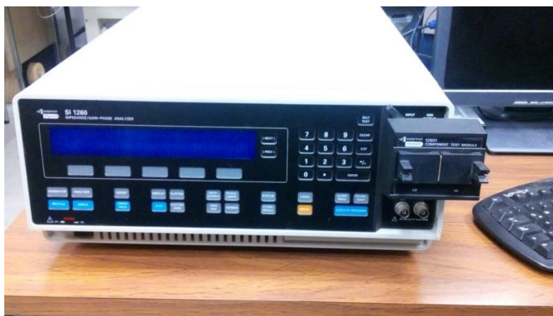
Figura 4-5. Espectrómetro de impedancias SOLARTRON SI 1260
