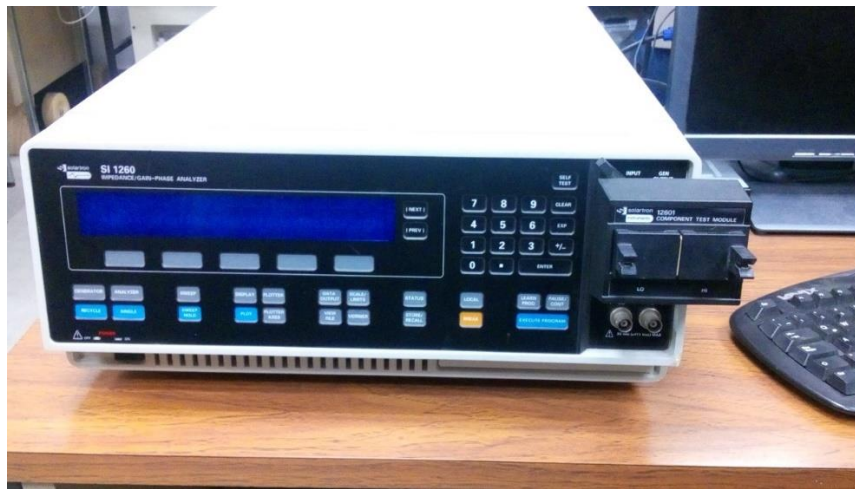
Figura 3-5. Equipo de espectroscopia de impedancia, SOLARTRON SI1260
