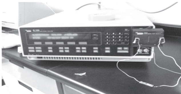
Figura 3. Se observa el equipo Solartron 1294 utilizado para medir la impedancia eléctrica y obtener los espectros de impedancia.
