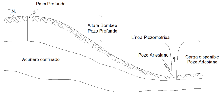
Fig.II.E.- Pozo Profundo y Artesiano.
