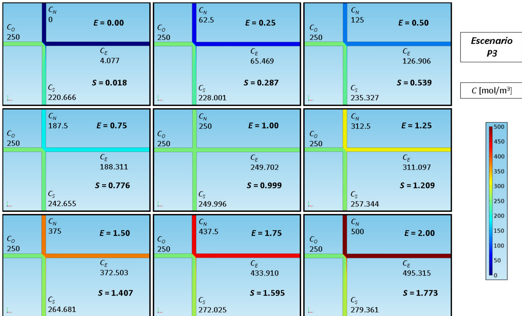
Figura 54. Concentraciones (mol/m 3 ) en las fronteras del cruce y valores de los coeficientes E y S del escenario P3 (Velocidades de entrada similares y velocidades de salida diferentes).
