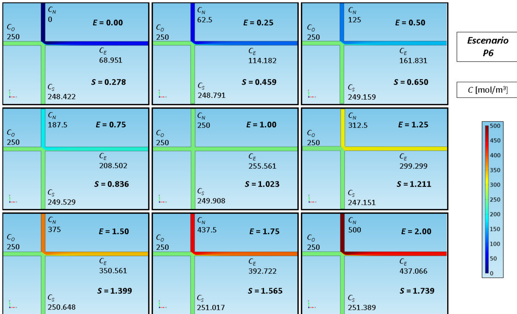
Figura 55. Concentraciones (mol/m 3 ) en las fronteras del cruceo y valores de los coeficientes E y S del escenario P6 (Velocidades de entrada diferentes y velocidades de salida similares).
