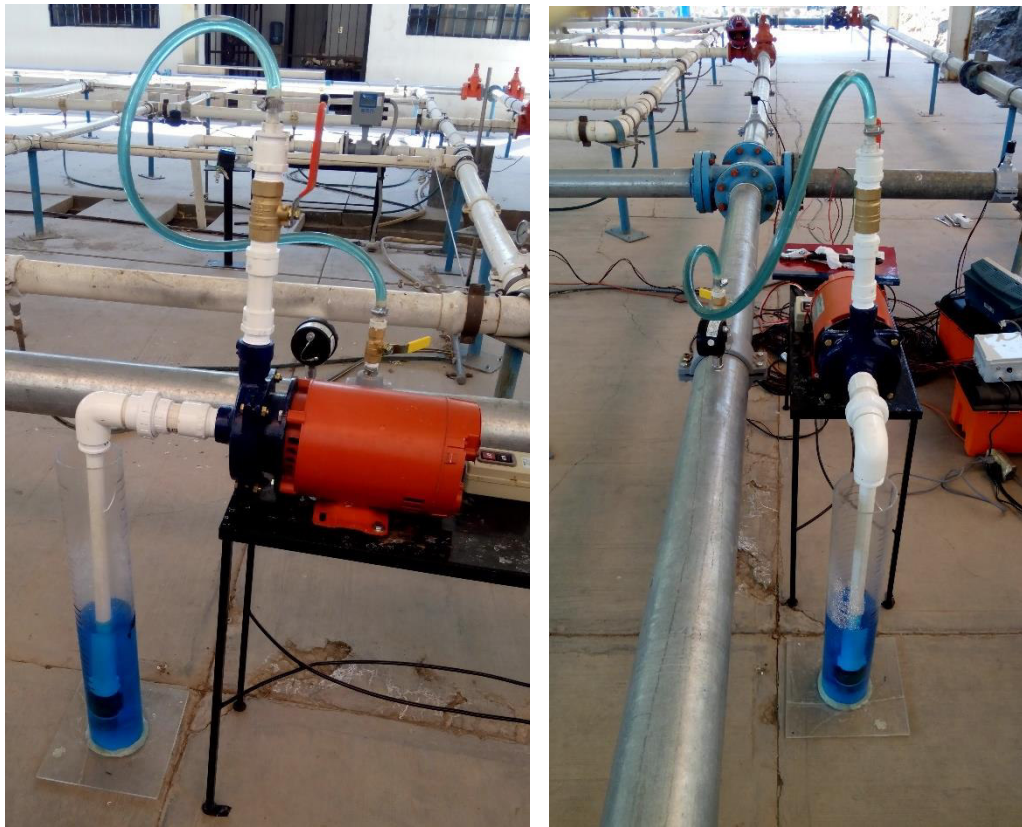
Figura 26. Inyección del trazador, vista lateral y frontal. El equipo de bombeo impulsa el trazador desde una probeta graduada hacia la tubería. El control se hace mediante una válvula de esfera.
