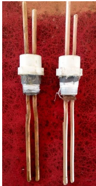
Figura 28. Electrodos manufacturados para la respuesta electroquímica. Se muestra un electrodo antes de realizar una prueba (lado derecho) y uno después de realizar la prueba. La adhesión del cobre se aprecia en el electrodo derecho.
