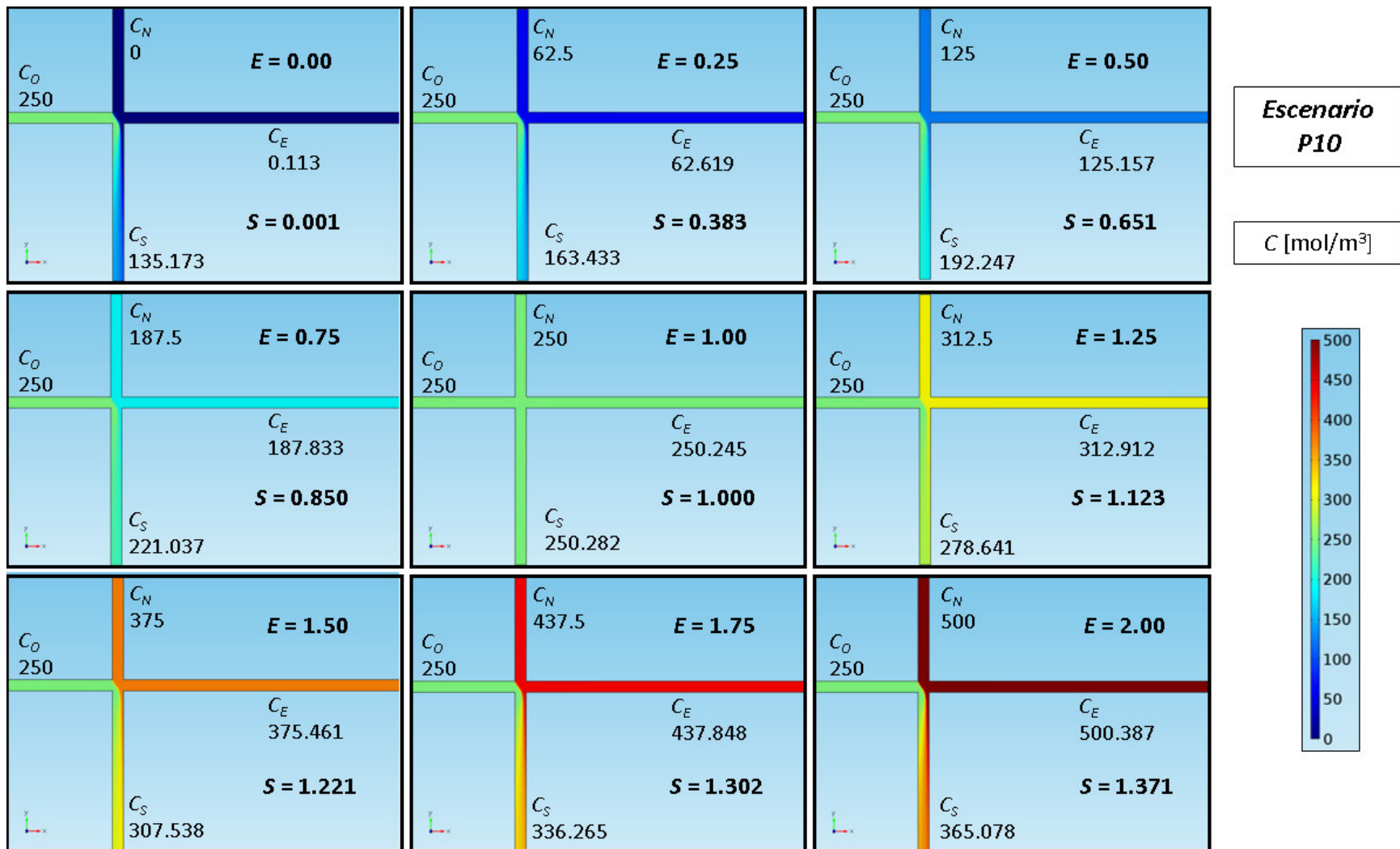
Figura 56. Concentraciones (mol/m 3 ) en las fronteras del crucero y valores de los coeficientes E y S del escenario P10 (Velocidades de entrada y velocidades de salida diferentes).
