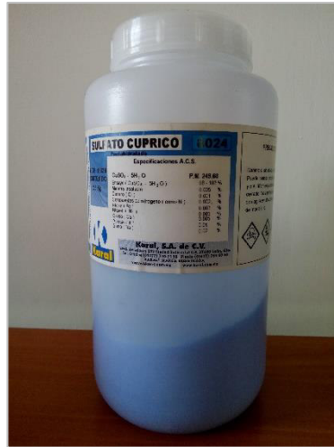
Figura 25. Trazador Sulfato de Cobre utilizado para los ensayos en el crucero.
