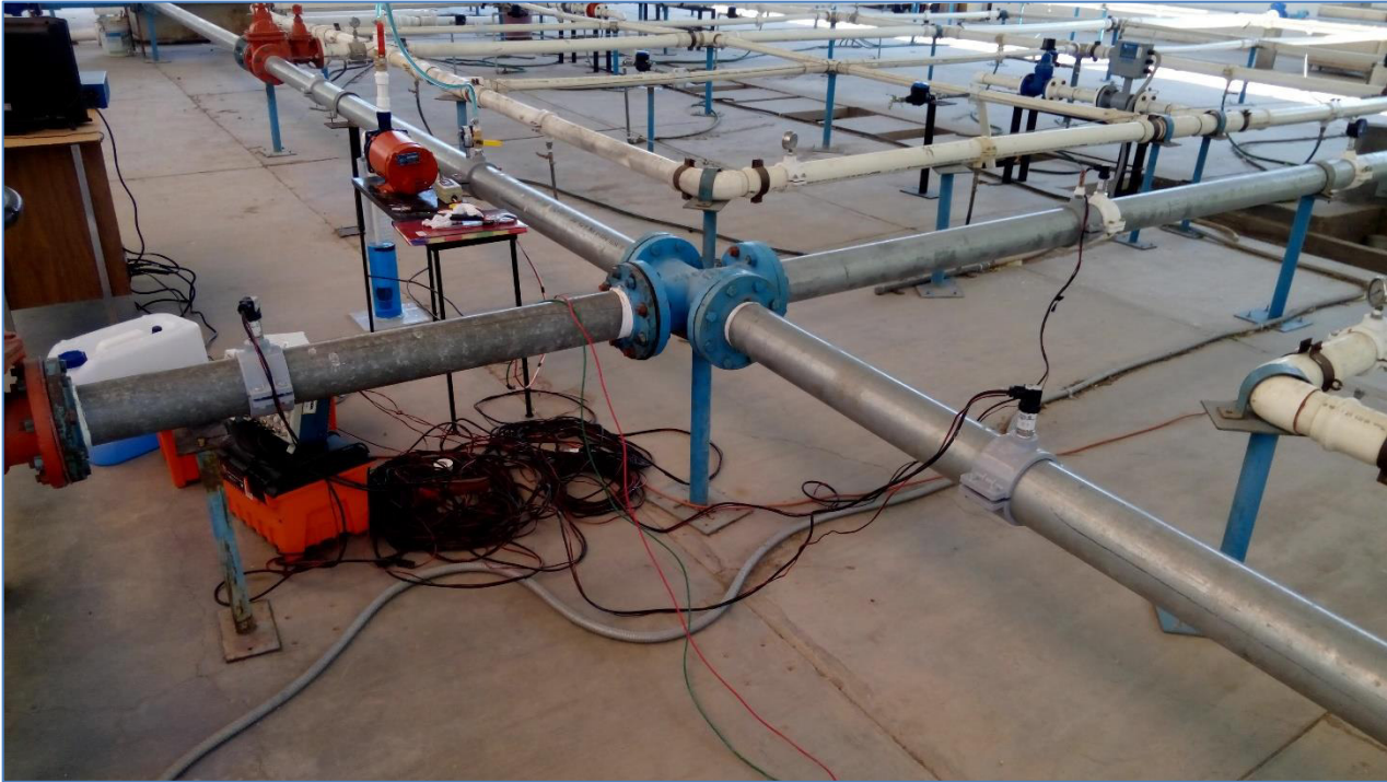
Figura 30. Montaje de dispositivos de medición, inyección y detección en el crucero experimental.
