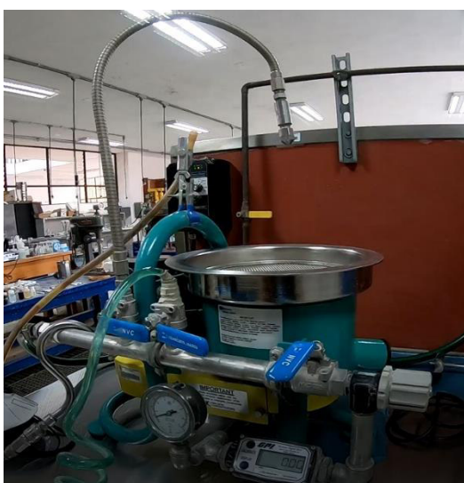
Figura 12: Fotografía de concentrador centrífugo y condiciones de trabajo del equipo de concentración gravimétrica, Knelson.
