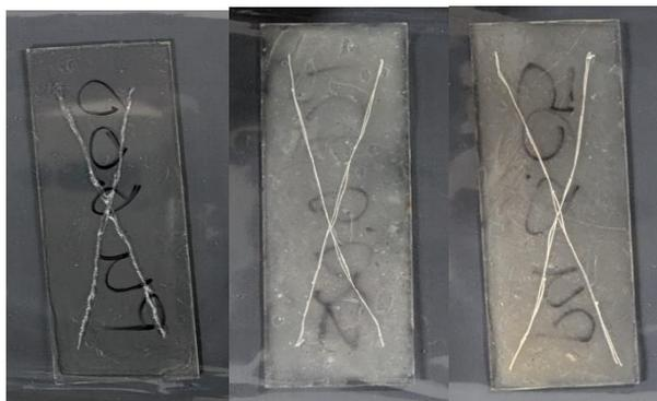
*Figura 5. Placas con el recubrimiento, antes de la exposición al flujo de calor. Porcentaje de nanopartículas, de izquierda a derecha, 0%, 0.025% y 0.05%.*
