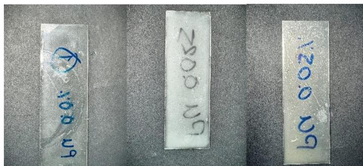
*Figura 3.* Placas con el recubrimiento, antes de la exposición a la luz UV. Porcentaje de nanopartículas de izquierda a derecha, 0%, 0.025% y 0.05%.
