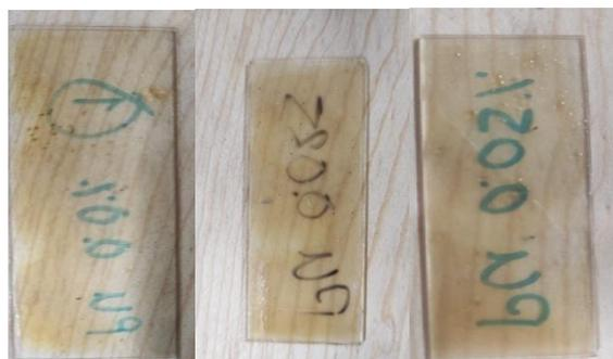
*Figura 4.* Placas con el recubrimiento, después de la exposición a la luz ultravioleta por 24 h. Porcentaje de nanopartículas, de izquierda a derecha, 0%, 0.025% y 0.05%.
