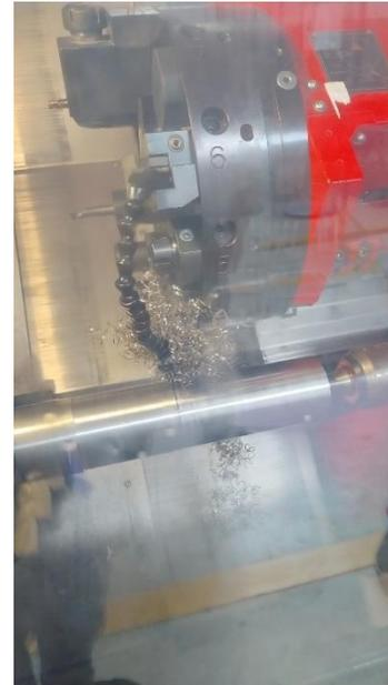
Figura 19. Realización de Pruebas con el MQL
