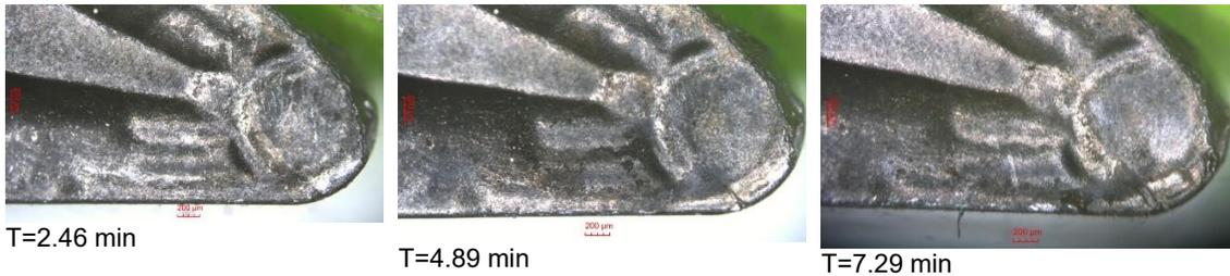
Figura 22. Desgaste la cara de arrastre de la herramienta en condiciones de corte en seco.
