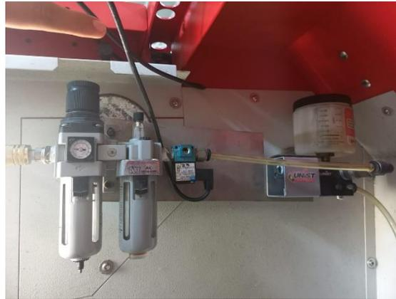
*Figura 16. Instalación del MQL dentro del torno*
