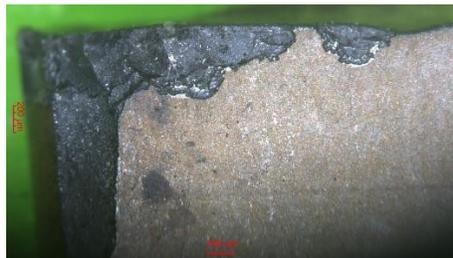
Figura 23. Desgaste en la cara posterior del inserto.
