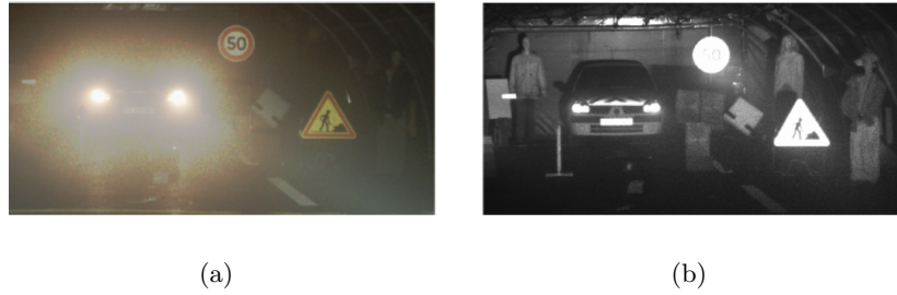
Figura 2.5: Comparación de una escena capturada con una cámara RGB convencional (a) y la misma escena con una cámara de rango controlado (b). Adaptada de Li et al. (2019) [21].
