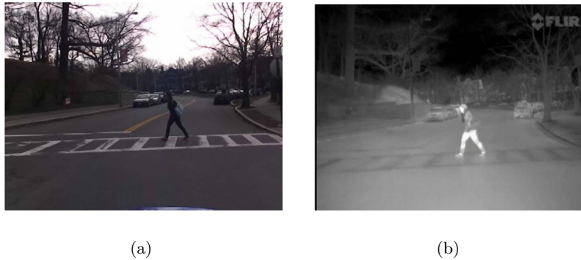
Figura 2.3: Diferencia entre una imagen tomada con una cámara RGB convencional (a) y una tomada con una cámara térmica (b). Adaptada de: Chen et al. (2019) [22].
