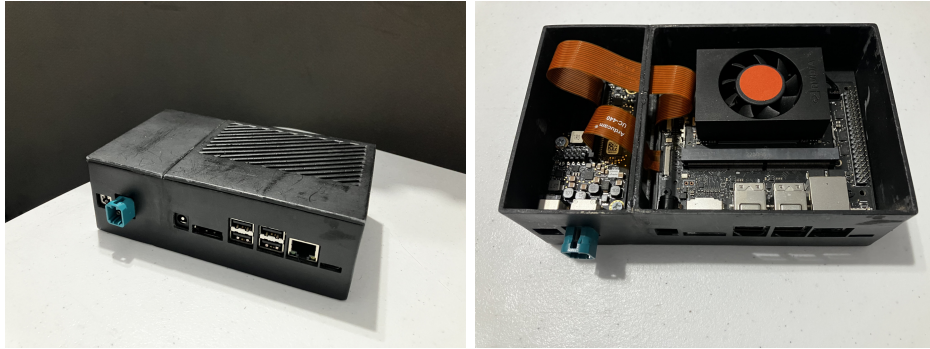
Figura 4.2: Caja de resina para las tarjetas del módulo de captura.
