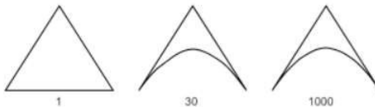
Figura 2.7. Razón Jacobiana de elemento triangulares [10].
