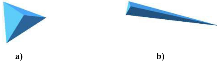
Figura 2.5. Elementos tetraédricos. a) Elemento con razón de aspecto 1.0 y b) Elemento con razón de aspecto alta [14].
