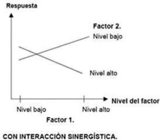
Figura 5.5. Tipos de interacción. a) Factores sin interacción, b) Factores con interacción antagonica y c) Factores con interacción sinérgica [74].
