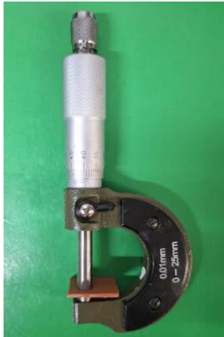
Figura 8.43 Medición de los espesores de película mediante micrómetro.
