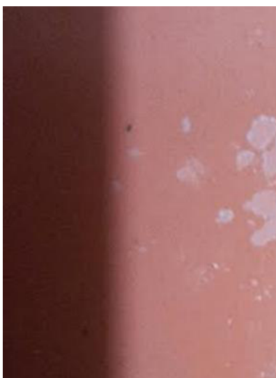
Figura 8.59 Muestra de plástico recubierto de emulsión de GMA después de la prueba de adhesividad.
