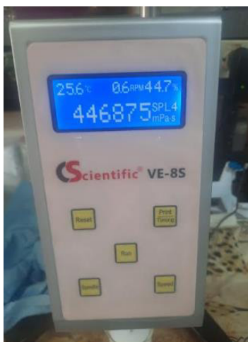
Figura 8.27 Determinación de viscosidad de emulsión 1 mediante aguja rotativa con el modelo de Ostwald Waale.
