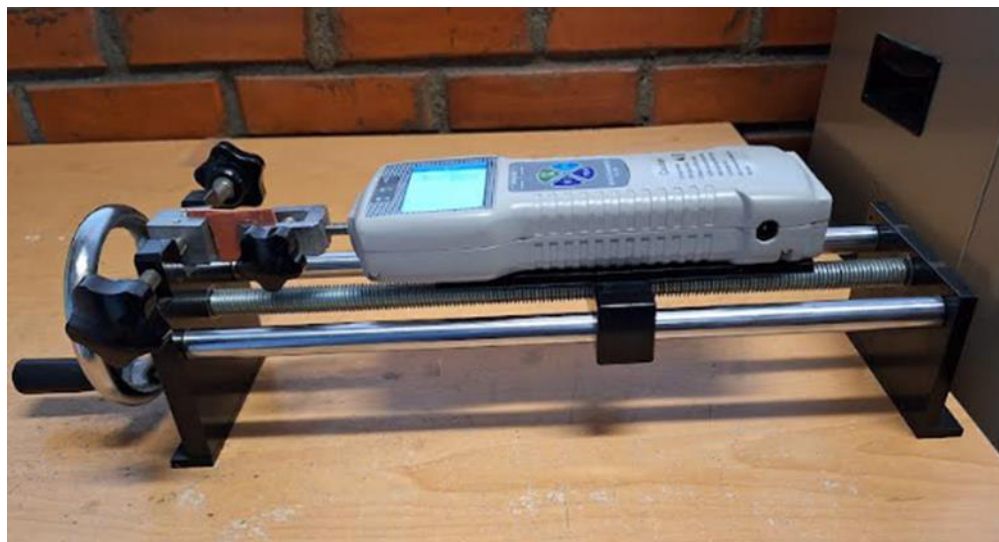
Figura 8.61 Pruebas de tensión sobre probetas unidas mediante las emulsiones.
