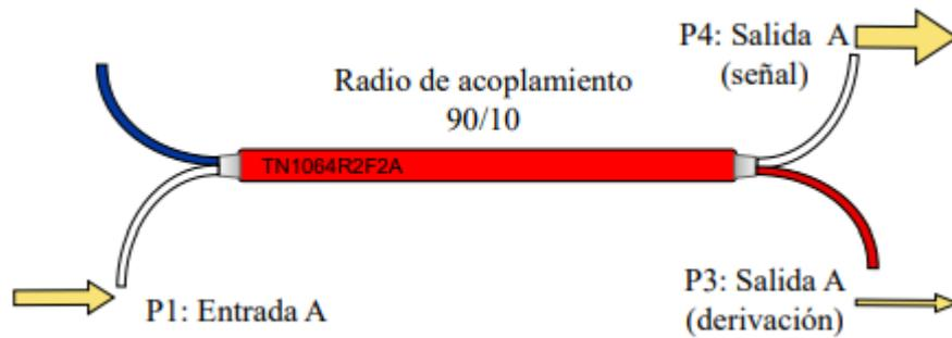
Figura 3. 11 Acoplador de fibra óptica 2x2 90/10.
