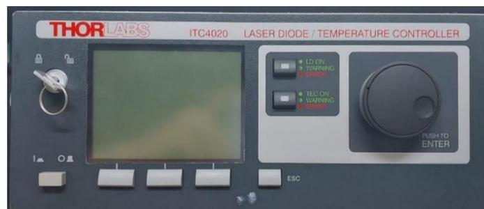
Figura 3. 1 Controlador de corriente y temperatura ITC4020, Thorlabs<sup>®</sup>.
