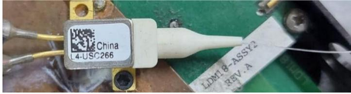
Figura 3. 2 Diodo láser como fuente de bombeo 6398-L4i, JDSU®.
