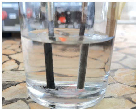
Figura 10. Sistema utilizado en la síntesis electroquímica de las nanoestructuras de carbono. Constituido de un ánodo y cátodo de grafito 99.99% de pureza.
