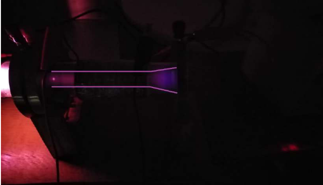
Figura 4.21: Trayectoria de los iones en el sistema de extracción y detección, se observó que al pasar las partículas por el solenoide, éstas se enfocan y forman un haz bien definido, cuya intensidad de corriente se registró en el amperímetro.
