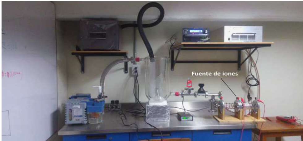
Figura 4.17: Fuente de iones conectada a los equipos correspondientes para generar y acelerar las partículas, con la finalidad de detectarlos en el amperímetro.
