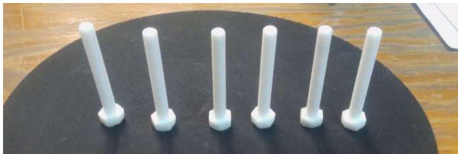
Figura 3.15: El diseño del tornillo MX1, se exportó al programa Ultimaker Cura 4.0, encargada de vincular el objeto con su impresión. Se imprimió en un PLA Blanco con 95 % de relleno y una resolución de 0.1 mm a 210° C en la boquilla extrusora.
