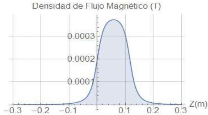
Figura 4.2: Densidad de flujo magnético a través de la longitud L_z de la bobina a corriente constante I_0 = 7.5 A, esta longitud coincide con la longitud de la cámara de vacío. El eje horizontal Z(m) representa la dirección donde se encuentra ésta, desde el punto (0,0) hasta (0,116,0) , en el eje vertical se muestra la densidad de flujo magnético en Tesla.
