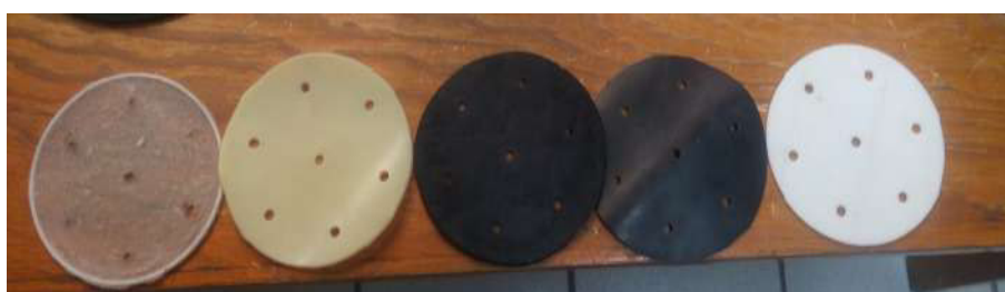
Figura 3.16: Empaques de unión entre el reactor de plasma y el sistema de extracción: silicón, PVC, caucho, nitrilo y PLA (de izquierda a derecha). El dispositivo se ensambló y se probó el mejor material que mantenía el vacío esperado, según los resultados de las simulaciones.
