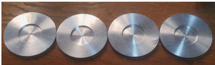
Figura 3.12: Maquinado de los elementos de aluminio, con las dimensiones expuestas en los planos de diseño.
