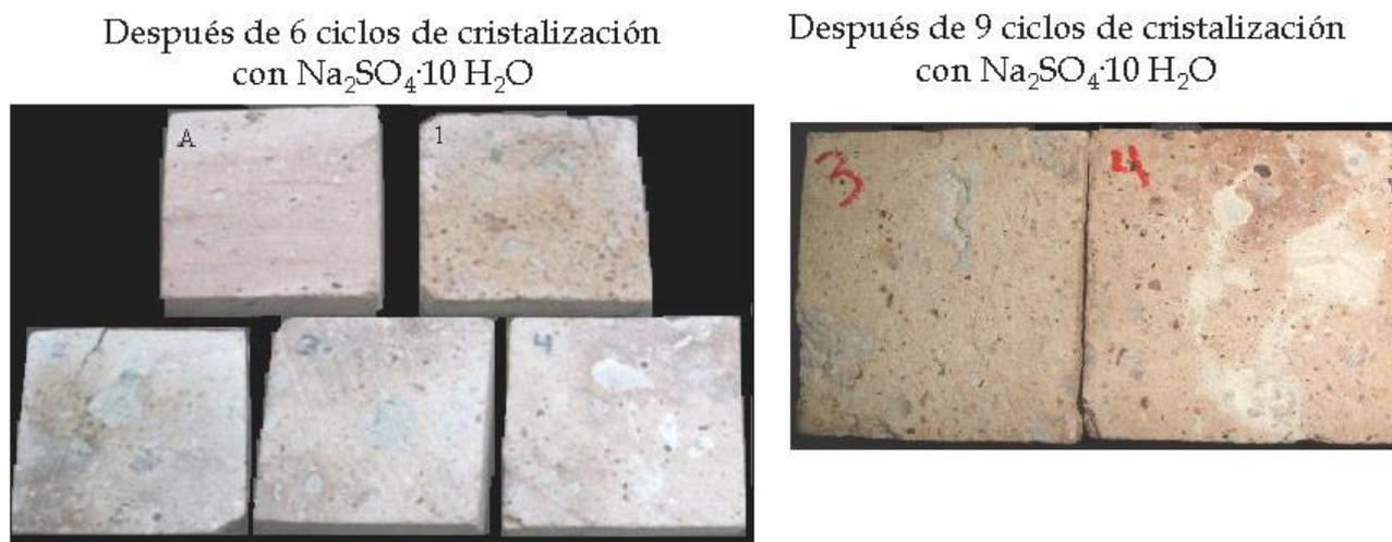
Figura 7.6. (A) cantera rosa sana sin exponer a ensayos de cristalización. Cantera rosa expuestas a la cristalización de  $\text{Na}_2\text{SO}_4 \cdot 10\text{H}_2\text{O}$  (1) Sin tratamiento (2) Tratada con TEOS-ME (3) Tratada con Ormosil (4) Tratada con H-ME
