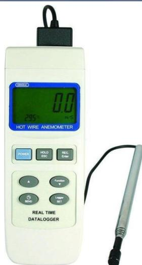
**Figura 19. anemómetro HWA2005DL de hilo caliente.**
