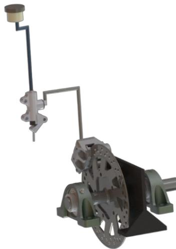
**Figura 16. Montaje del sistema de frenado.**
