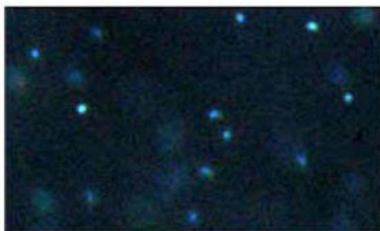
**Figura 1.10.** Nanopartículas de plata de 60 nm utilizadas en citodiagnóstico observadas en un microscopio óptico con la técnica de campo oscuro. [106]
