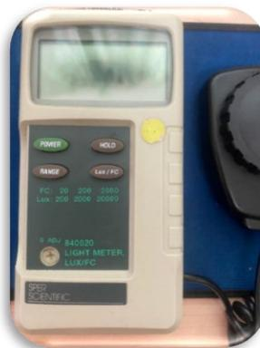
**Figura 9.** Luxómetro marca Sper Scientific
