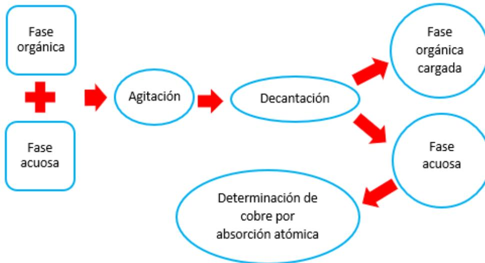
Figura 3.6. Procedimiento experimental para la extracción líquido-líquido por lotes.
