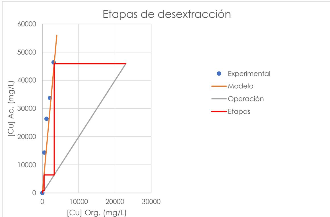
Figura 4.18. Etapas de desextracción a relación O/A=2;  $Y_i=23$  g/L;  $X_i=45.89$  g/L;  $[H_2SO_4]=2$  mol/L; Tiempo= 10 min.
