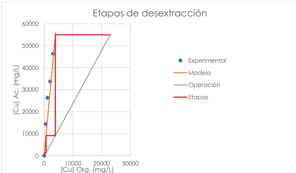
Figura 4.16. Etapas de desextracción a relación O/A=2.4;  $Y_i=23$  g/L;  $X_f=54.97$  mg/L;  $[\text{H}_2\text{SO}_4]=2$  mol/L; Tiempo= 10 min.
