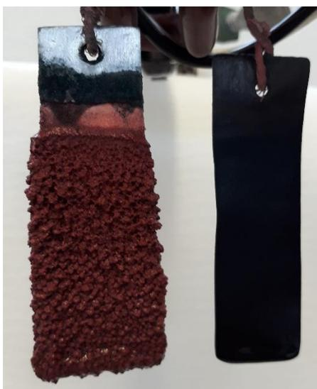
Figura 4.28. Electrodo de acero inoxidable 316L (izquierda) y electrodo de plomo (derecha), después de la electrodeposición.
