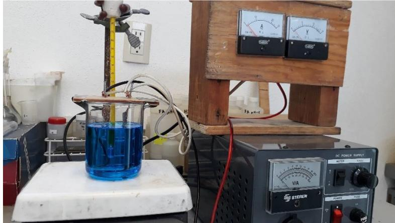
Figura 3.7 Sistema para la electrodeposición de cobre.
