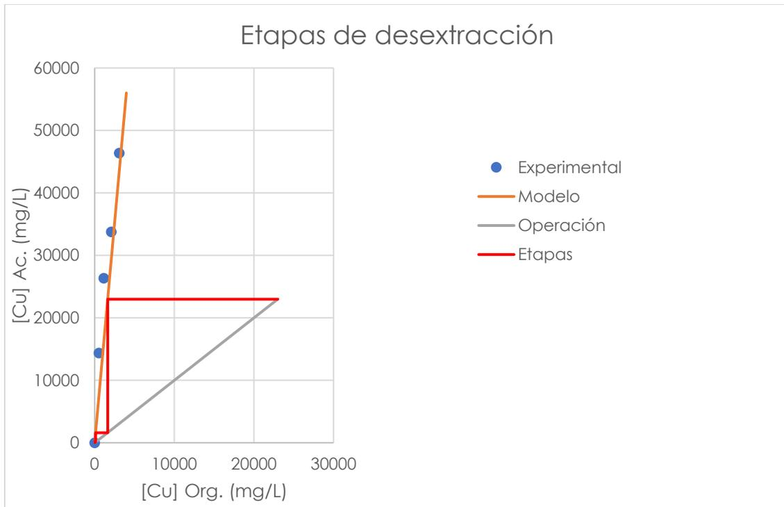
Figura 4.21. Etapas de desextracción a relación O/A=1;  $Y_i=23$  g/L;  $X_f=22.99$  g/L;  $[H_2SO_4]=2$  mol/L; Tiempo= 10 min.
