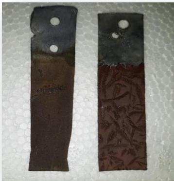
Figura 4.23. Depósito de cobre en la placa de acero inoxidable (derecha) y placa de plomo (izquierda).
