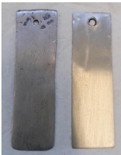
Figura 4.27. Electrodo de acero inoxidable 316L (derecha) y electrodo de plomo (izquierda), antes de la electrodeposición.
