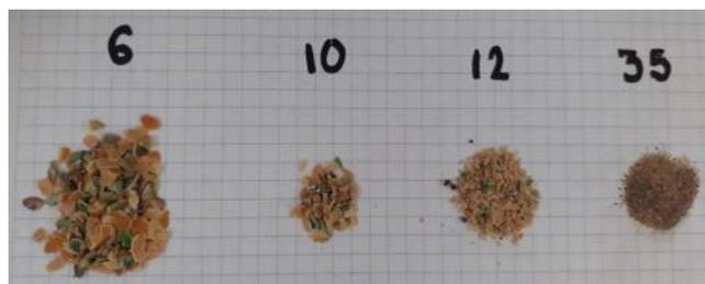
Figura 3.4. Distribución del material después de la clasificación.
