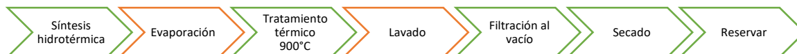
Figura 12. Ruta de síntesis implementada en este trabajo, para aumentar la actividad catalítica.
